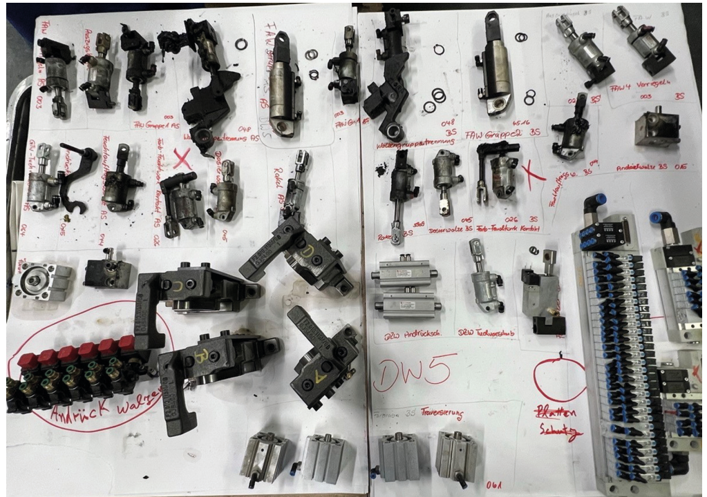
Abb. 3: Ausgebaute pneumatische Stellglieder eines Druckwerks.
